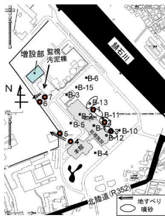
図 浄化センター内の地盤調査箇所
