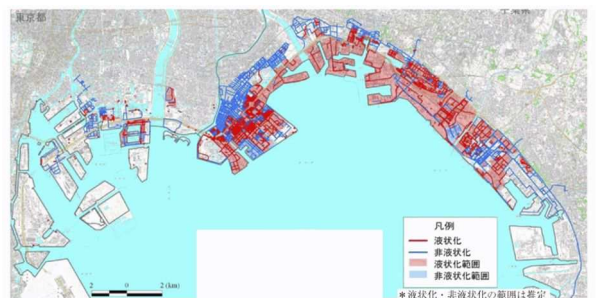
図4：東京湾岸の液状化の状況
